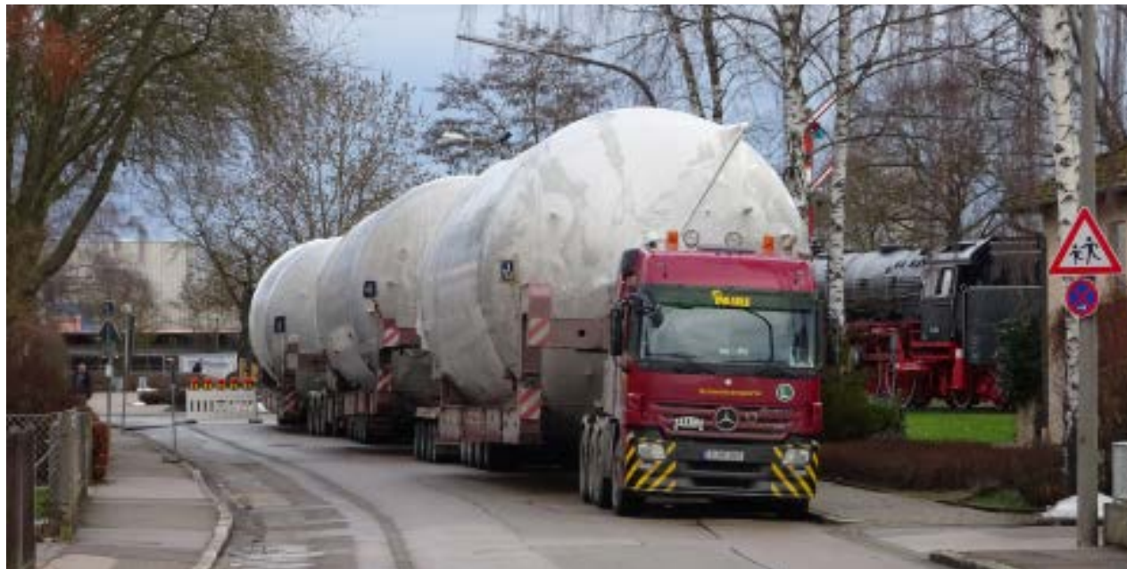
Aufwändiger Schwertransport nach Treuchtlingen: Die Wassertanks wurden beziehungsweise werden in zwei Wellen angeliefert.
